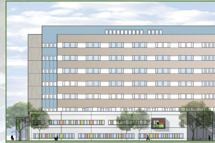
Den nya byggnaden är formad med utgångspunkt i sjukhusets befintliga grundstruktur och har släta, ljusa betongfasader. Nybyggnationen ansluter till befintlig byggnad via Röda gatan i entréplanet (plan 2).
