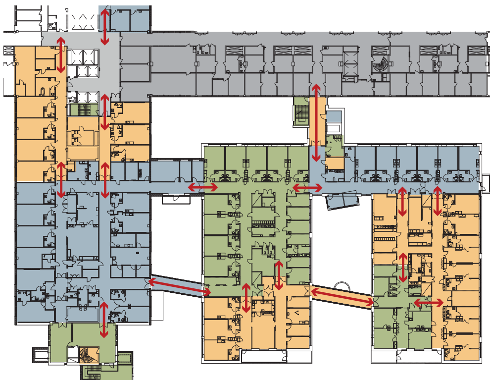
Brandcellsindelning och utrymning, plan 3
